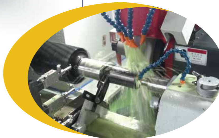
工件名稱:變速箱斜齒輪 產品型號:PGP-3260CNC
