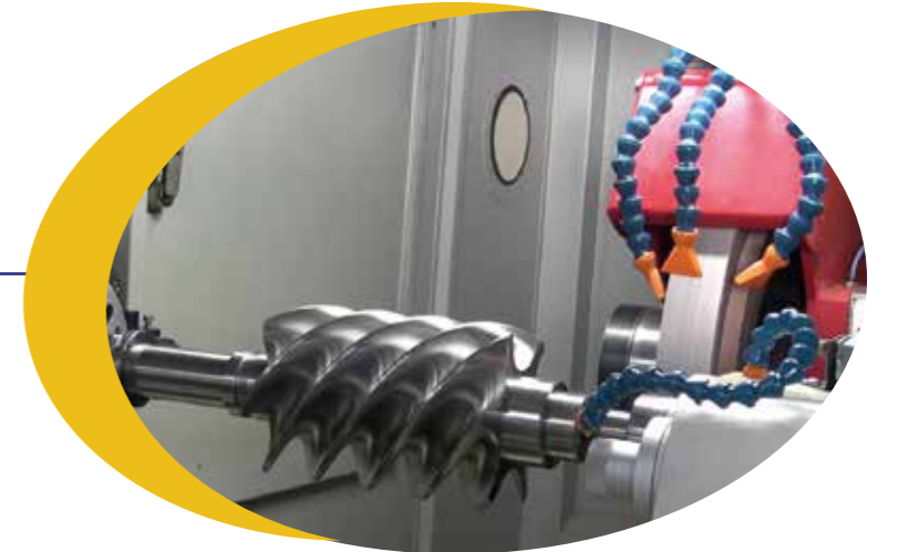
工件名稱:空壓機轉子 產品型號:PGP-3260CNC
