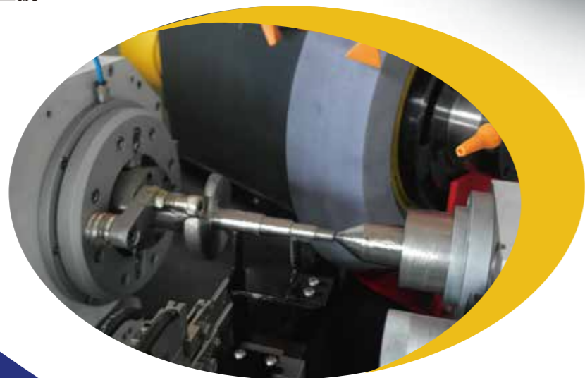
工件名稱:曲柄軸 產品型號:PGA-3260CNC
